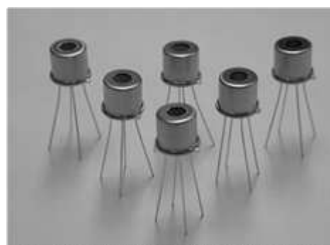
〈写真3〉 当社のサーモパイル・センサの外観
