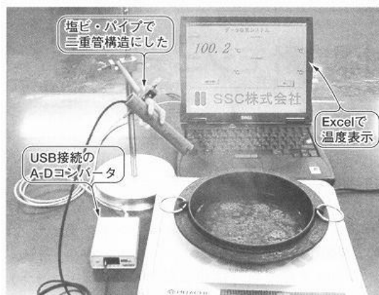
〈写真7〉 沸騰水の温度を測定中のようす
